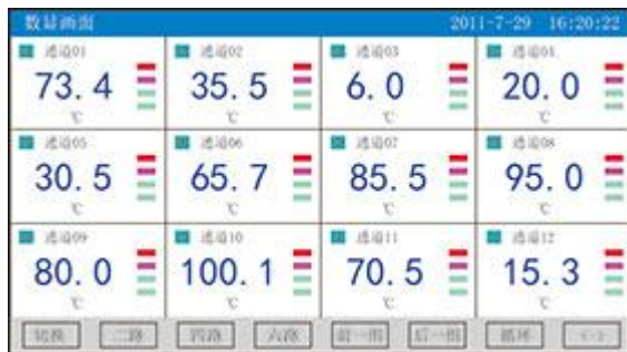
显示实时测量值、通道位号、工程单位及报警状态可
